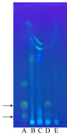
图1 薄层色谱分析 A: 北桑寄生总黄酮; B: ZC020粗提物; C: ZC026粗提物; D: ZS042粗提物; E: ZZ105粗提物。箭头所指为ZS042菌株的粗提物与对照品迁移率相同,颜色一致的黄绿色荧光斑点
