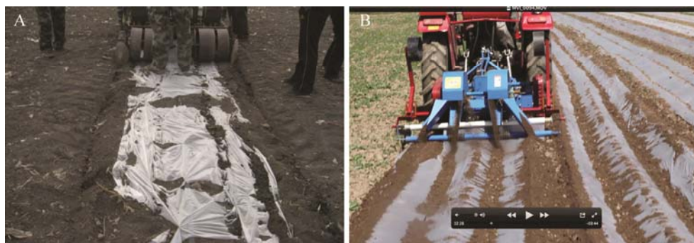
图2 生物降解地膜上机试验(A:强度不够,无法作业;B:能够正常作业)
